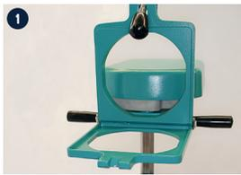
Das Heizelement nach hinten drehen, den Rahmen mithilfe der beiden schwarzen Griffe vollständig nach oben schieben und öffnen.
