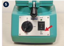
Wenn die Folie 1,5 bis 2 cm durchgesackt ist, den Schalter auf VACUUM (=) stellen, den Rahmen ruhig nach unten bringen, über das Gipsmodell drücken und das Heizelement nach hinten drehen.
