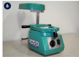
Den Vakuummotor noch 30 bis 60 Sek. laufen lassen und dann ausschalten. 2 bis 5 Min. warten und dann den Rahmen öffnen. Die Abkühldauer variiert je nach Tiefziehfolie.
