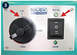
Das Heizelement nach vorn bis über den Rahmen drehen. Den Timer auf ca. 10 Minuten und den Schalter auf HEATING (-) einstellen. Das Gerät vorheizen lassen.
